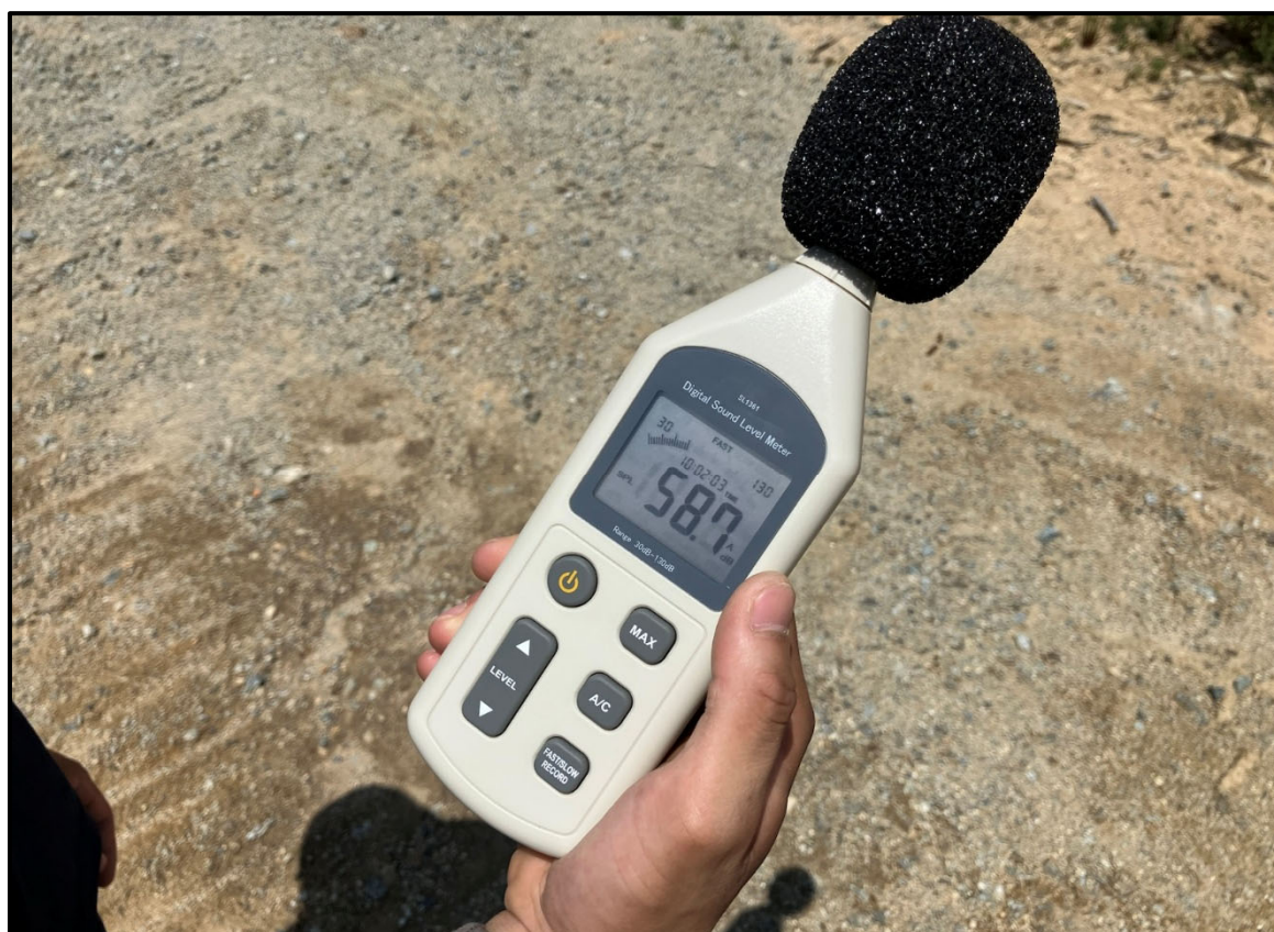
図-2 調査状況と結果 (No. 1騒音測定地点)
