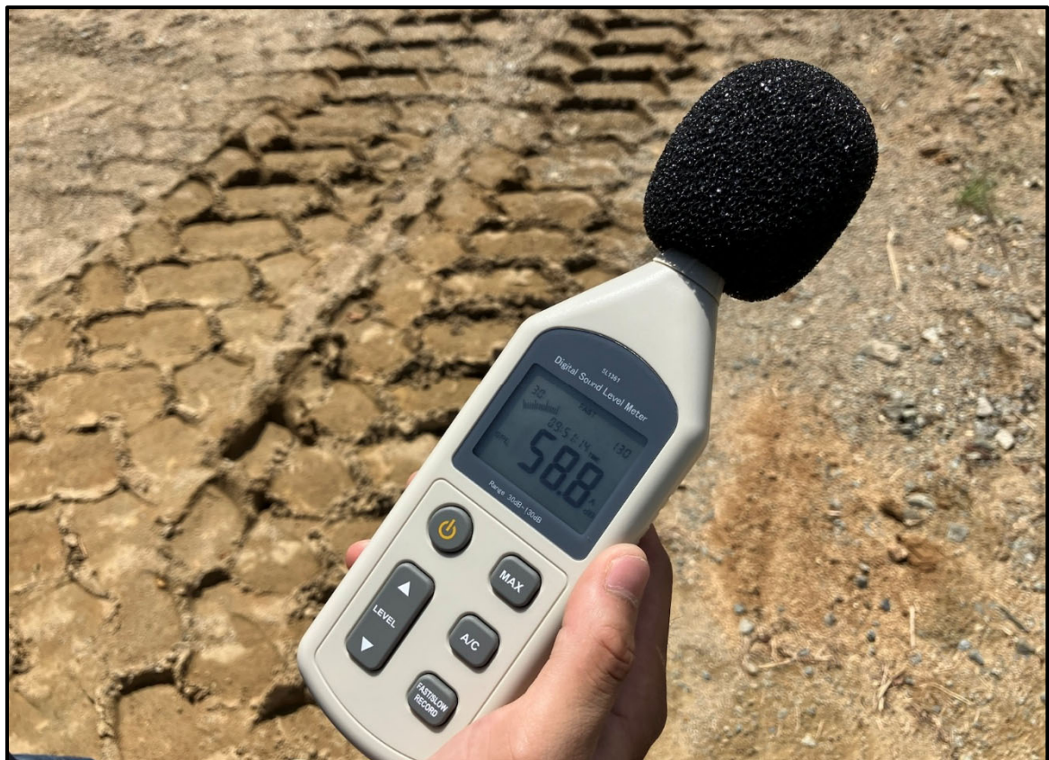
図-3 調査状況と結果 (No. 3騒音測定地点)
